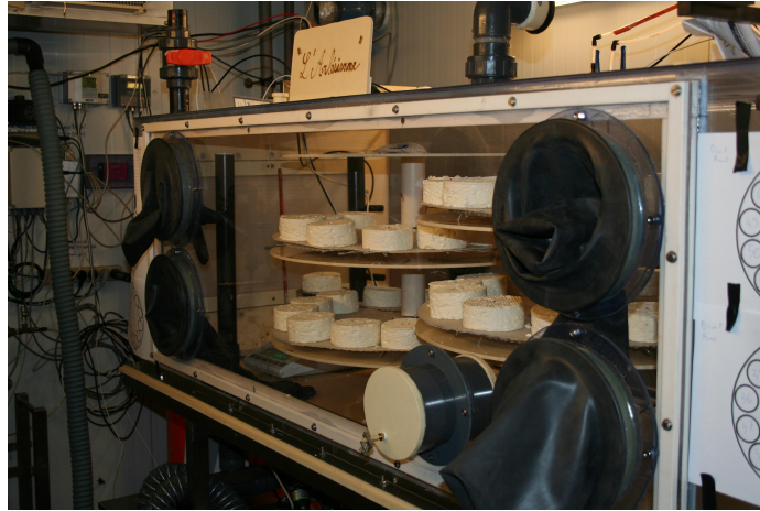
FIGURE 3.10: L'Arlésienne, hâloir pilote d'une capacité de 70 fromages installé dans une chambre thermostatée.
